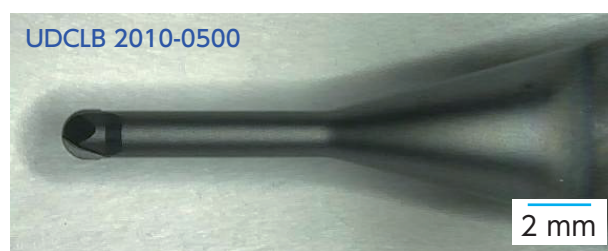
・有効長5 mmの加工 体積 131.9 \text{ mm}^3 時間 76.5 min Tool #2 milled 131.9 \text{ mm}^3 in 76.5 minutes.
